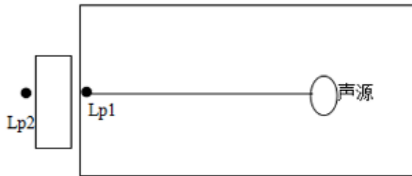
图 4-2 室内声源等效为室外声源图例
