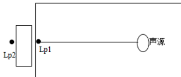
图 4-2 室内声源等效为室外声源图例
